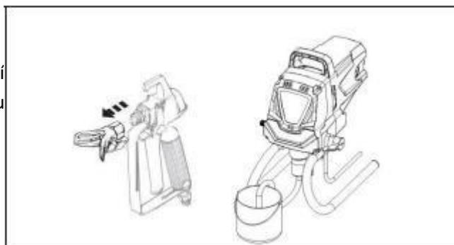
Umístěte nádobu na odpad vedle originální nádoby na materiál. Namiřte stříkací pistoli na boční stranu originální nádoby na materiál a přidržte spoušť.
