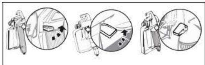
Otočte otáčecí knoflík PRIME/SPRAY do polohy PRIME. Vypněte čerpadlo (O). Odpojte stříkací pistoli od napájení.
