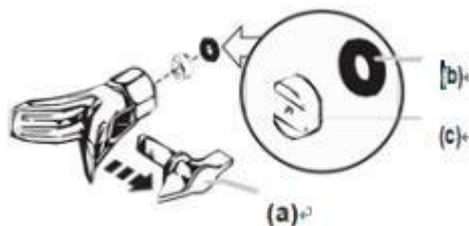
Nejprve namontujte konec filtru pistole. Stříkací pistoli znovu smontujte.
