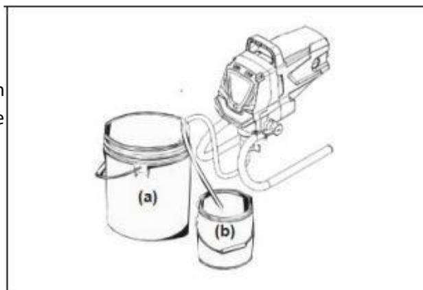
Otočte otáčecí knoflík pro nastavení tlaku na maximální tlak. Otočte otáčecí knoflík PRIME/SPRAY do polohy PRIME.
