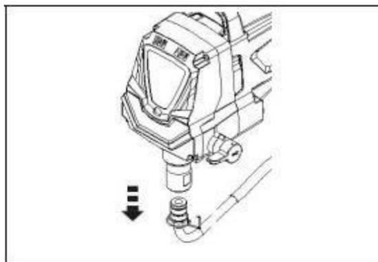
Odšroubujte sestavu vstupního ventilu (a) ze stříkací pistole. Vizuálně zkontrolujte vnitřní a vnější stranu sestavy vstupního ventilu. Veškeré zbytky barvy očistěte vhodným čistícím roztokem.
