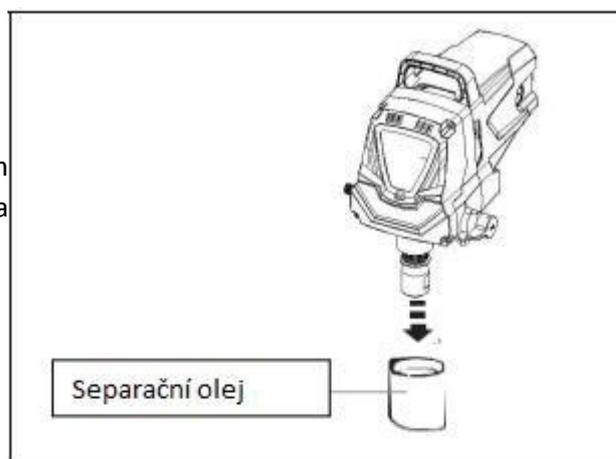
Umístěte hadřík nad přípojku stříkací hadice a zapněte přepínač (I). Když je olej z kelímku nasátý, vypněte čerpadlo (O).
