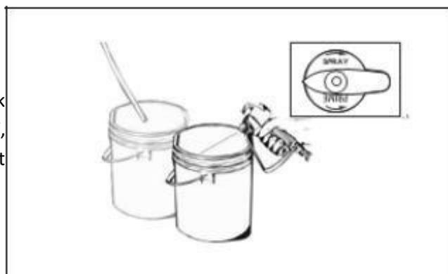
Když čistící roztok vytéká ze stříkací pistole, držte spoušť a miřte stříkací pistoli na boční stranu nádoby na odpad.
