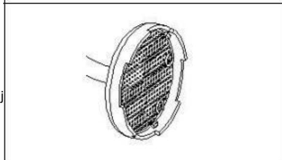
Zkontrolujte, zda jsou těsnění uvnitř adaptéru a sací hadice. Na zahradní hadici nasadte adaptér na čištění čerpadla. Připojte hadici a adaptér ke konektoru na konci sací hadice.
