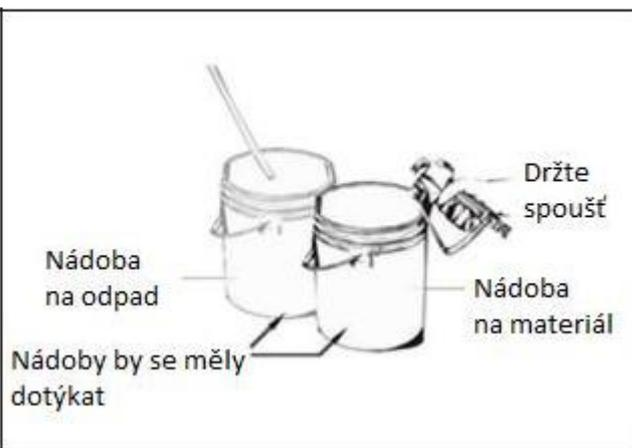
Při držení spouště pistole, zapněte čerpadlo (I) a otočte otáčecí knoflík PRIME/SPRAY do polohy SPRAY, aby se materiál z hadice vypustil zpět do originální nádoby.
