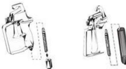
Vyjměte stříkací trysku (a) ze sestavy krytu proti rozstříkávání. Očistěte stříkací trysku měkkým kartáčkem a vhodným čistícím roztokem. Ujistěte se, že podložka (b) a sedlo (c) ze zadní strany sestavy krytu proti rozstříkávání byly demontovány a vyčištěny.
