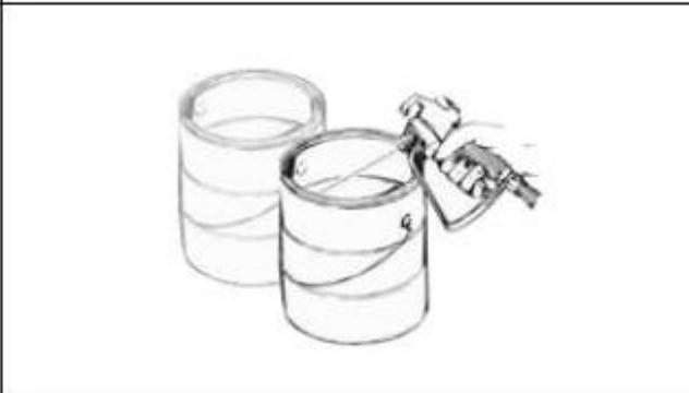
Zatímco čisticí roztok vytéká ze stříkací pistole, držte spoušť a namiřte stříkací pistoli na boční stranu nádoby na odpad (stříkací pistole s kovovou nádobou při proplachování hořlavým rozpouštědlem).
