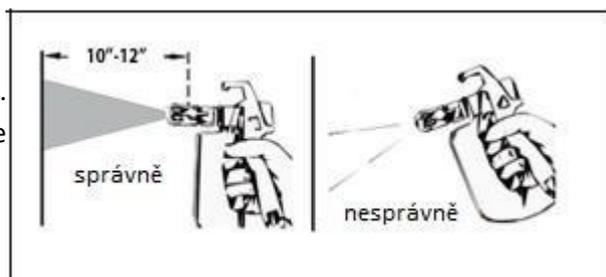
Spouštění pistole po zahájení tahu. Před ukončením tahu uvolněte spoušť. Stříkácí pistole by se měla pohybovat po stisknutí a uvolnění spouště. Překryjte každý tah přibližně o 30 %. To zajistí rovnoměrný povlak.
