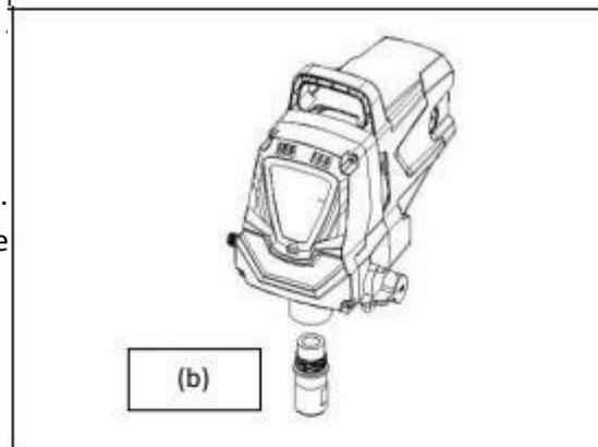
Vyměňte a rukou utáhněte sací sestavu. Pokud problémy s nasáváním přetrvávají, může být nutné vyměnit sestavu vstupního ventilu. Zavolejte do servisu firmy POWERMAT a objednejte si novou sestavu vstupního ventilu.
