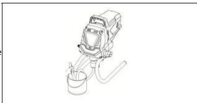
Otočte otáčecí knoflík PRIME/SPRAY do polohy PRIME. Připojte stříkací pistoli. Otočte přepínač do polohy ON (I).
