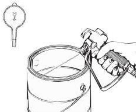
Uvolněte spoušť. Otočte otáčecí knoflík PRIME/SPRAY do polohy PRIME. Vypněte čerpadlo (O). Vystřelte pistoli do nádoby na odpad, abyste se ujistili, že v hadici nezůstal žádný tlak.
