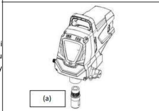
Namažte těsnící O-kroužek na vstupním ventilu (b). Vyměňte sestavu vstupního ventilu a zašroubujte do stříkací pistole. Kroutící moment 31 – 36.6 Nm.
