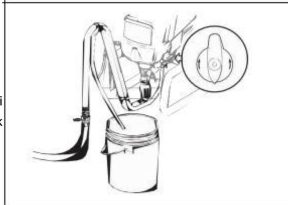
Zapněte přívod vody. Zapněte čerpadlo (I).
