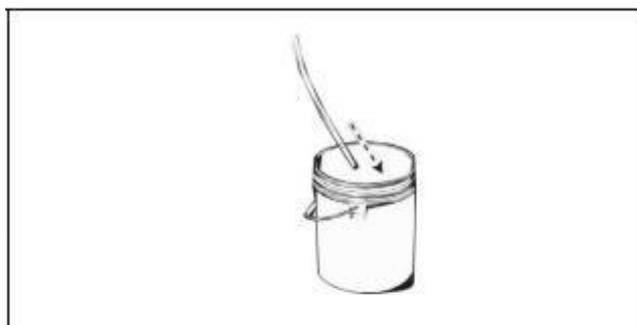
Umístěte originální nádobu na materiál vedle nádoby na odpad. Namiřte stříkací pistoli na boční stranu nádoby na originální materiál a přidržte spoušť.
